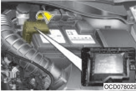
■ Motor bölümü sigorta paneli (Akü terminal kapağı)
